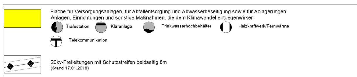
Abb. 53 Darstellungen der bestehenden Anlagen für die Ver- und Entsorgung
